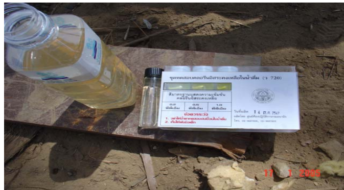
รูปที่ 2.7 การตรวจสอบคลอรีนตกค้างโดยใช้ชุดตรวจสอบของกรมอนามัย
