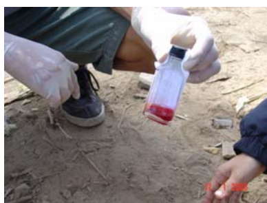
รูปที่ 2.4 ขั้นตอนการตรวจวัดเชื้อโคลิฟอร์มโดยชุดตรวจของกรมอนามัย
