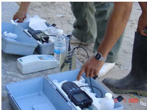
รูปที่ 2.3 ลักษณะเครื่องตรวจวัดคุณภาพน้ำ ได้แก่ ความเค็ม ความขุ่น และค่าพีเอช
