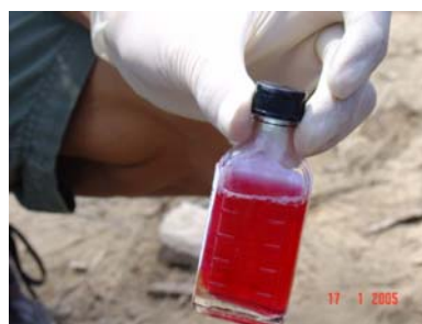
รูปที่ 2.4 ขั้นตอนการตรวจวัดเชื้อโคลิฟอร์มโดยชุดตรวจของกรมอนามัย
