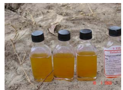
รูปที่ 2.4 ขั้นตอนการตรวจวัดเชื้อโคลิฟอร์มโดยชุดตรวจของกรมอนามัย
