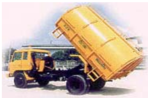
รูปแสดง รถยนต์บรรทุกขยะแบบเปิดข้าง – เทท้ายขนาดความจุ 10 ลูกบาศก์เมตร
