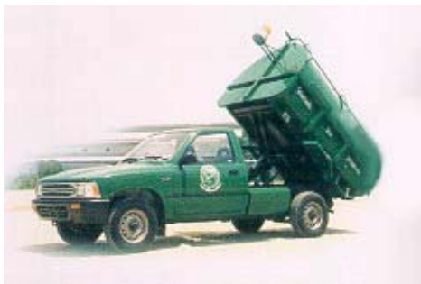
รูปแสดง รถยนต์บรรทุกขยะแบบเปิดข้าง – เทท้ายขนาดความจุ 3 ลูกบาศก์เมตร
