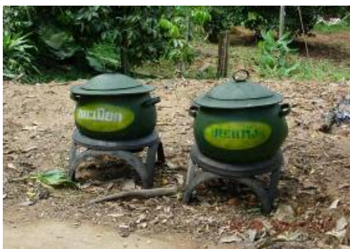
ถังขยะมูลฝอยแบบแยกประเภทที่ผลิตจาก ยางรถยนต์
