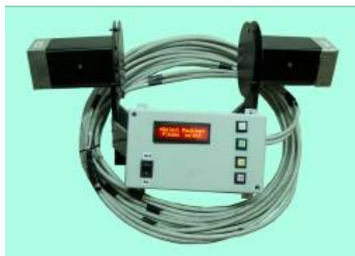
รูปที่ 14 เครื่องวัดควันดำระบบวัดความทึบแสงต้นแบบระยะที่ 1B
